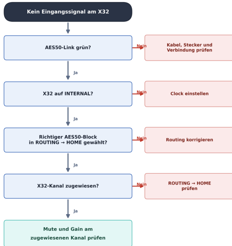
Abbildung 10: Fehlersuche – kein Eingangssignal am X32
