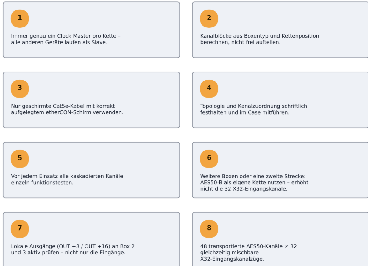
Abbildung 12: Grundregeln für stabile AES50-Kaskaden
