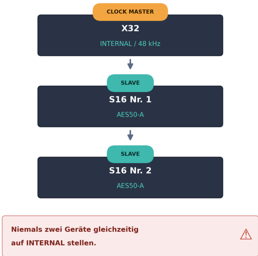
Abbildung 4: Clock-Master- und Slave-Prinzip
