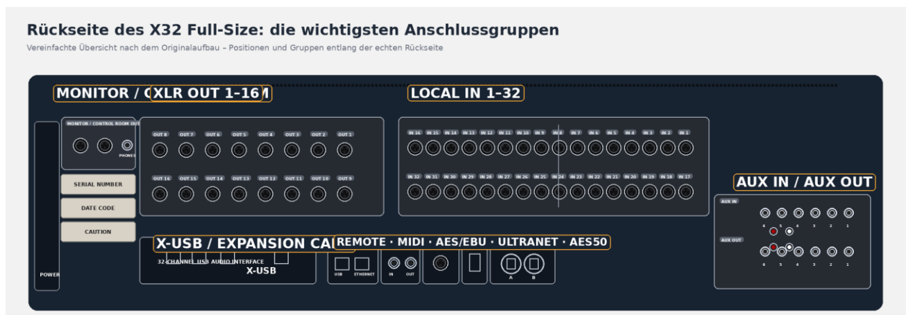
Abbildung 5: Die für Einsteiger wichtigsten Anschlussgruppen auf der Rückseite des X32 Full-Size. Eigene, vereinfachte Darstellung, nicht maßstäblich.
